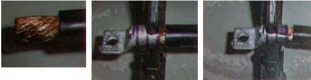
**Fig. 5.61.** Detalle de la secuencia de operación de prensado de un terminal de batería de tipo atornillado. Obsérvese como el prensado se efectúa en dos puntos, entre las marcas del terminal.
