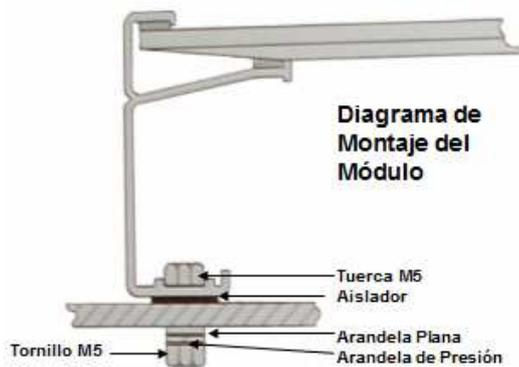
Fig. 5.50. Esquema facilitado con la documentación de un módulo fotovoltaico, en el que se detalla la fijación del marco a la estructura.
