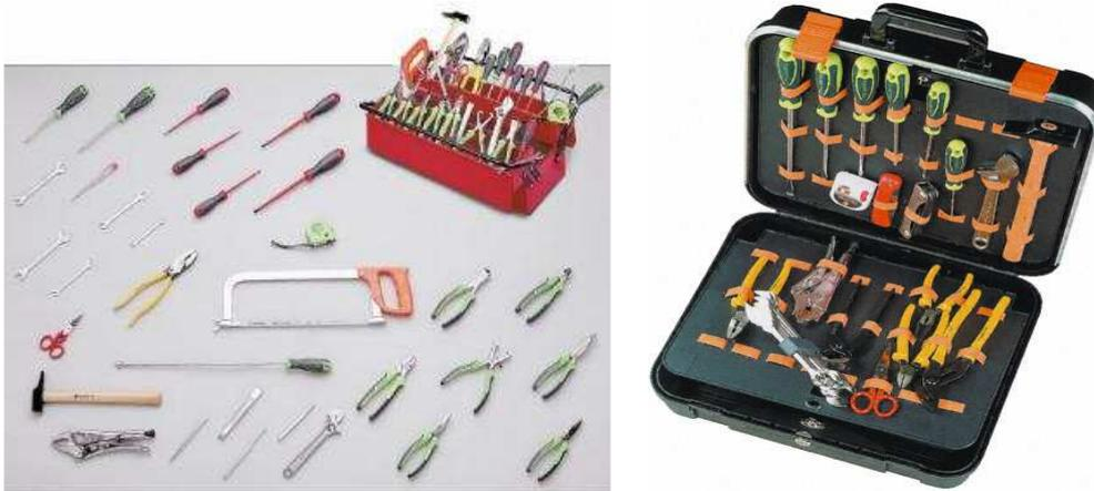
Fig. 5.72. Equipo para electricista desplegado, y típico maletín de herramientas.
