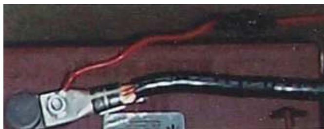
**Fig. 5.79.** A la izquierda se muestra el tipo de fusible (en línea) seleccionado por el profesional para realizar una operación indicada en el manual de instrucciones de un aparato de monitorización, que simplemente decía “coloque un fusible de 1 A y fusión rápida próxima a la conexión del cable positivo con la batería”. A la derecha se muestra el fusible montado y conectado.
