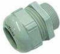
**Fig. 5.37.** Elementos de un “prensaestopa” (más propiamente, prensacables). La rosca de la derecha entra en el orificio de la caja de conexión del módulo y se fija mediante una tuerca. La tapa de la izquierda asegura el prensado del cable por medio de su interior cónico (cuanto más se enrosca la tapa, más se estrechará la parte flexible del prensaestopas).
