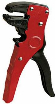
**Fig. 5.69. Pelacables autoajustable. Accionado con una sola mano, puede pelar y eliminar aislamiento de cables de hasta 10 mm<sup>2</sup>.**
